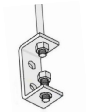
Exempel med ett U-beslag som upphängningsanordning. Beslaget monteras på ovansidan med skruv (M8x16).
