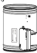
Illustration 1M. Montering af spjældmotor og regulator på cirkulært spjæld.
